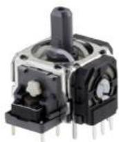
定番のスティックコントローラで、世界の据え置きゲーム端末機の8割以上のシェアを持っています。レバー(軸)の材料の違いにより金属軸のRKJXKシリーズと絶縁軸のRKJXVシリーズがあります。特にRKJXVシリーズでは小型化、堅牢化に加え、ゲームで重要なレバーの復帰精度も向上しています。
