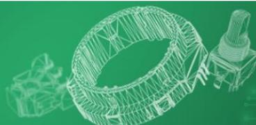
可変抵抗器(ポテンシオメータ)が機械的な位置の変化をアナログ電気信号に変換するのに対し、エンコーダは、これをデジタル信号に変換します。エンコーダも可変抵抗器と同じくポジションセンサと操作デバイス両方の用途で様々な電気機器に使用されていますが、ここでは操作デバイスとしてのエンコーダについてご紹介します。ポジションセンサとしてのエンコーダ(磁気式)については[こちら](#)
