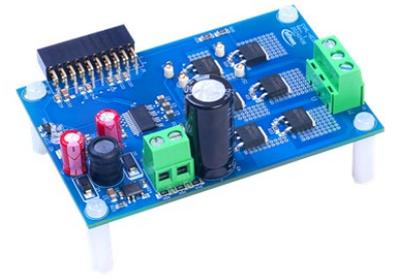
評価ボード EVAL-6EDL04I065PRは、インフィニオンの最新のSOI (silicon-in-insulator) EiceDRIVER™ ゲートドライバIC 6EDL04I065PRおよび TRENCHSTOP™ RC-IGBT IKD06N60RC2を使用した、コンパクトでコスト効果の高い三相インバータブリッジが搭載されており、ブラシレス直流 (BLDC) モーター制御用に設計されています。
