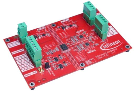
本ボードは、インフィニオン製 ProFET™ ITS6035S 2個とデジタルアイソレーター4DIR2400Hを組み合わせて、電流容量が最大DC4 Aの2つの24 Vデジタル出力を実現しています。本リファレンスボードは診断機能を搭載した2つのハイサイドパワースイッチに対応し、最大5700 Vrmsの絶縁電圧を備えているため、安全な絶縁に最適です。
