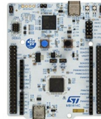
NUCLEO-H503RB NUCLEO-H533RE 安価な試作設計が可能 USB, Arduino Uno IF, 64ピン・パッケージ搭載
