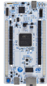
NUCLEO-H563ZI 安価な試作設計が可能 USB, イーサネット, Arduino Uno IF, 144ピン・パッケージ搭載
