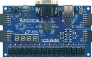
・Basys 3 は、Vivado Design Suite向けに設計されたエントリーレベルのFPGA開発ボードで、Xilinx Artix-7アーキテクチャを備えています
