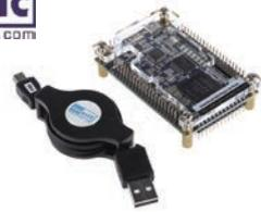
・DE0-NANOボードは、ロボットや携帯品プロジェクトなどの回路設計試作に最適の小型サイズのFPGA開発プラットフォームです
