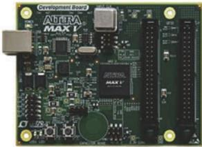
・Altera MAX V CPLD開発キットは、I/O拡張、インターフェイスブリッジ、電源管理制御、初期化制御、アナログインターフェイス制御など、最も一般的なCPLDアプリケーションのプロトタイプに必要なハードウェアとソフトウェアの両方を備えた完全な設計環境です
